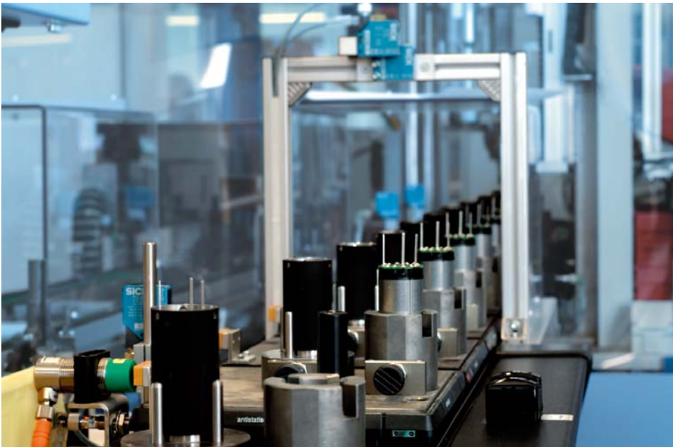
Bild 1: Vollautomatisierte Fertigung der Serie ECI 63
