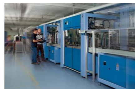
Vollautomatische Rotor-Fertigungsstraße mit 100%iger Prozessüberwachung
