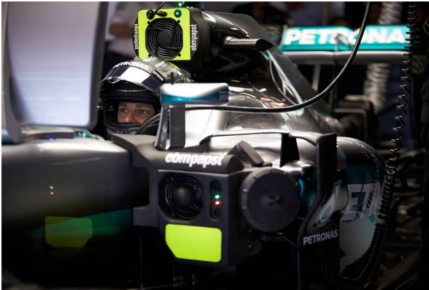
Bild 1: Ein Kühlkonzept von ebm-papst führt die Stauwärme über die Seitenkästen- und die Überrollschutz-Öffnungen ab.
