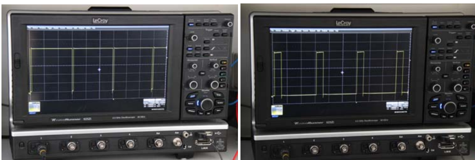
Bild 2a, b Die Restlebensdauer kann digital per PWM-Signal a) high, b) low oder über ein zusätzliches RC-Glied auch analog ausgegeben werden
