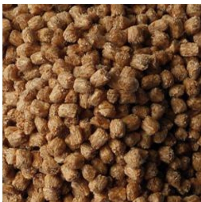
Bild 2: Der Holz-Kunststoff-Verbundwerkstoff epylen®
