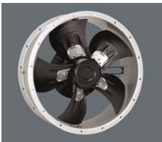
Bild 1: Aufbau eines kompletten, für Ex-Bereiche der Zone 2 und 1 zugelassenen Axialventilators. Der Wandring aus Blech bildet zusammen mit den HyBlade®-Flügeln aus einem speziellen Hochleistungskunststoff eine nicht zündfähige Materialkombination.
