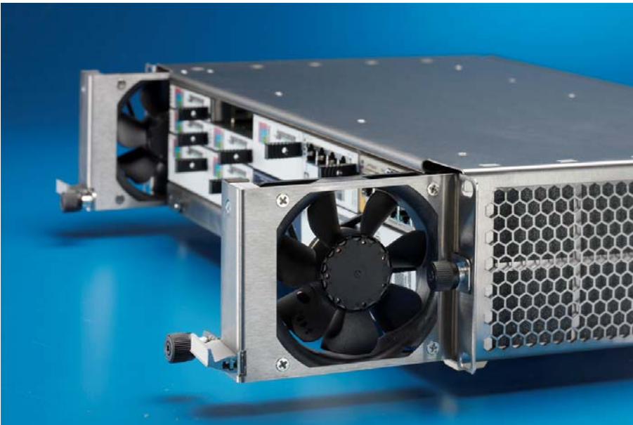
Bild 2: Lüftung horizontal. Lüfter mit vorgeschaltetem Schutzgitter (Bild Rittal)
