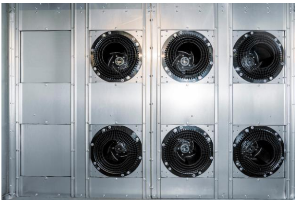
Bild 2b: Sollte einer der Ventilatoren ausfallen, wird die Drehzahl der übrigen erhöht, sodass die Luftleistung stets gleich bleibt. Das macht diese Lösung besonders zuverlässig für kritische Anwendungen.
