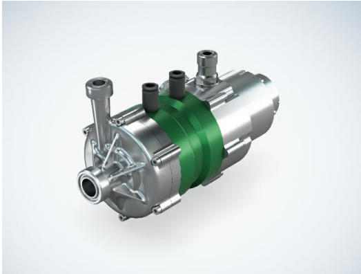
Bild 1: ebm-papst entwickelt Turboverdichter im elektrischen Leistungsbereich von 1 kWe bis ca. 55 kWe, die variable Fördermengen verschiedener Kältemittel ermöglichen und durch interne Volumenreduzierung von 90 % mit deutlich weniger Kältemittel auskommen (Beispiel Verdichter P2).
