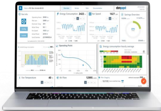
Bild 1: Die epCloud ist das Zentrum, in dem die Anlagendaten zusammenlaufen und überwacht werden können. Hier werden auch die Basisfunktionen und Digital Services abgebildet.
