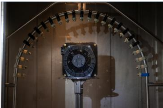
Bild 3: In der IP-Prüfkammer werden Elektronik und Ventilatoren standardisierten Schutzart-Tests gemäß IP-Code gegen Eindringen von Feuchtigkeit unterzogen.
