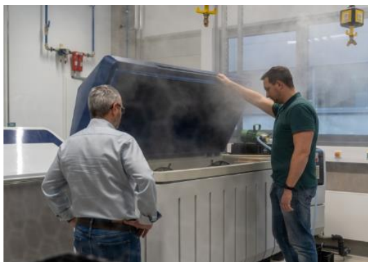
Bild 4: In der Salznebelprüfkammer wird die Qualität der Beschichtungen und Materialien untersucht.
