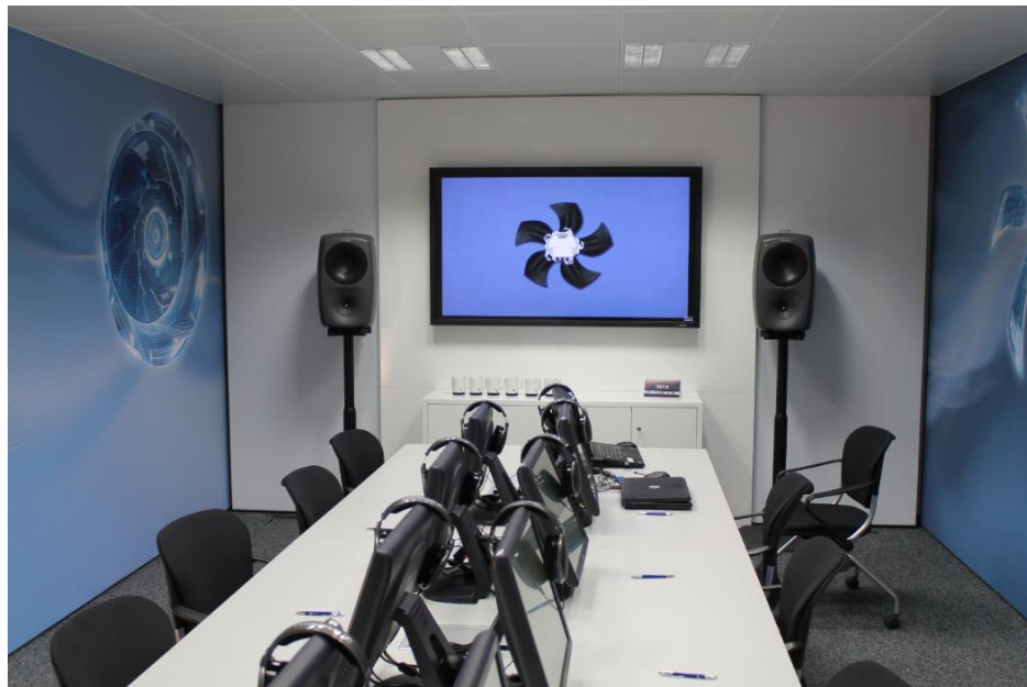
Bild 1: Das Psychoakustik-Labor für Testhörer bei ebm-papst in Muldingen.
