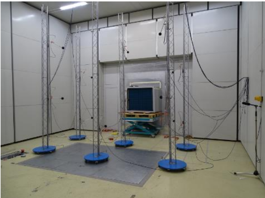
Bild 2: In den Testeinrichtungen von ebm-papst werden Wärmepumpen samt den darin verbauten Ventilatoren strömungstechnisch und akustisch erfasst.
