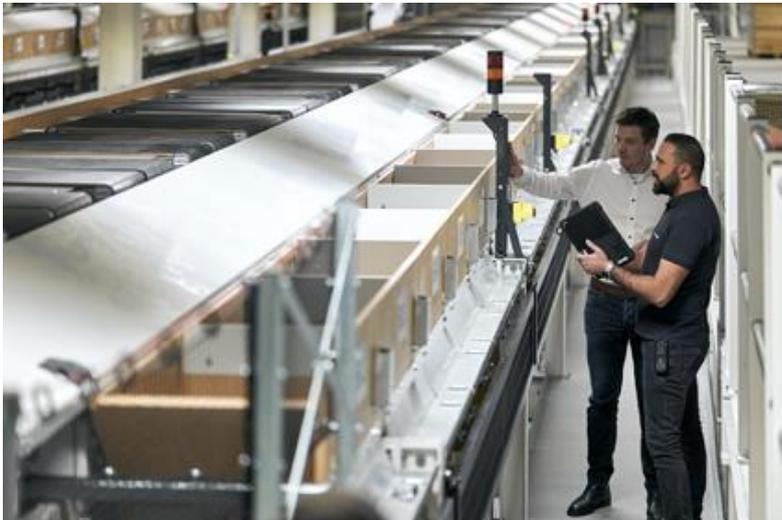
Bild 1: Die 275 Meter lange Anlage der BEUMER Group im Logistikzentrum Weiden sortiert über 10.000 Artikel pro Stunde.
