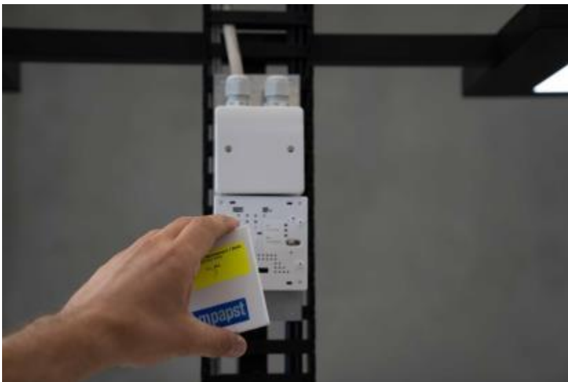
Bild 2: Die zertifizierten Sensoren messen permanent die Luftqualität und schicken ihre Daten in die cloudbasierte Building Connect Plattform von ebm-papst, die diese weiterverarbeitet.
