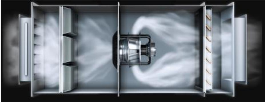
Bild 1: Klappen und Filter können den Luftstrom in RLT-Anlagen behindern und auch der Abstand zu Wänden und Wärmetauschern sowie der Einsatz von Schutzgittern wirken sich aus, daher muss frühzeitig die reale Einbausituation betrachtet werden, um am Ende der Entwicklung ein optimales Ergebnis zu erreichen.
