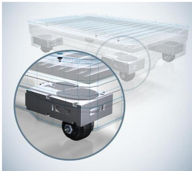
Bild 1: Das Fahr-Lenk-System ArgoDrive von ebm-papst für fahrerlose Transportfahrzeuge ist eine Einheit bestehend aus Motoren, speziellem Getriebe, Sensorik und allen erforderlichen Anschlüssen und erlaubt flächenbewegliches Navigieren.
