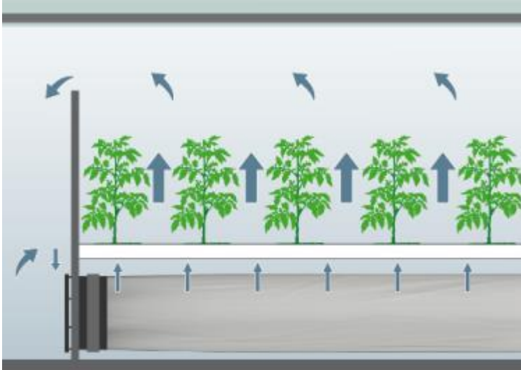
Bild 3: Bei der Schlauchbelüftung erfolgt die Luftzufuhr von unten. So sind die Blattunterseiten optimal mit CO 2 versorgt.
