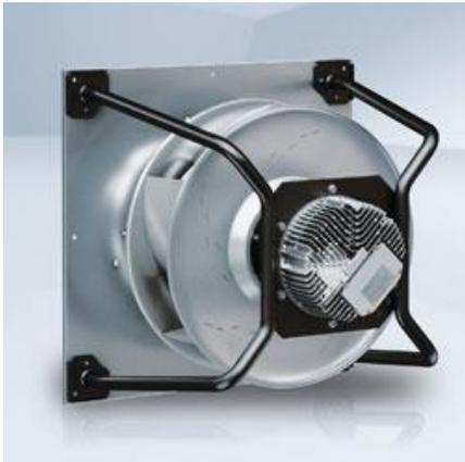
Bild 2: Im Schiffsbau zählt jeder Kubikzentimeter: Bei EC-Ventilatoren der RadiPac-Baureihe ist das Hochleistungslaufrad direkt auf dem Rotor des Außenläufermotors befestigt. Das macht das System äußerst kompakt.
