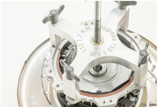
18. Setzen Sie den Abzieher auf und schrauben diesen an allen vier Gewindebohrungen im Stator fest. Lösen Sie den Stator indem Sie die Spindel des Abziehers im Uhrzeigersinn drehen.
