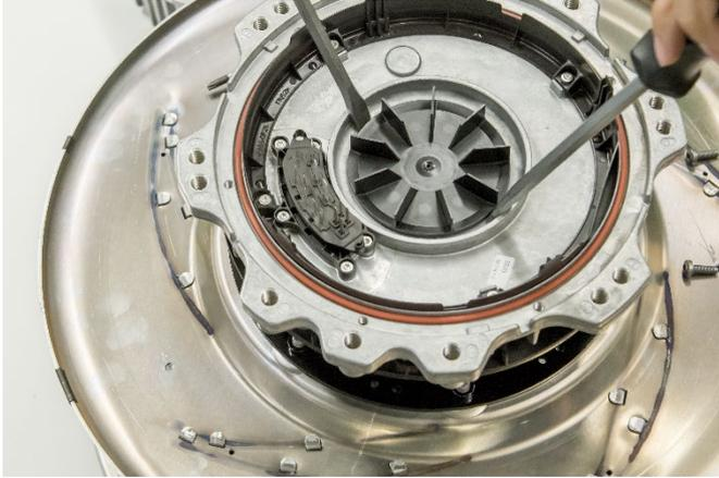
16. Hebeln Sie das Lüfterrad mit zwei Schraubendrehern heraus.
