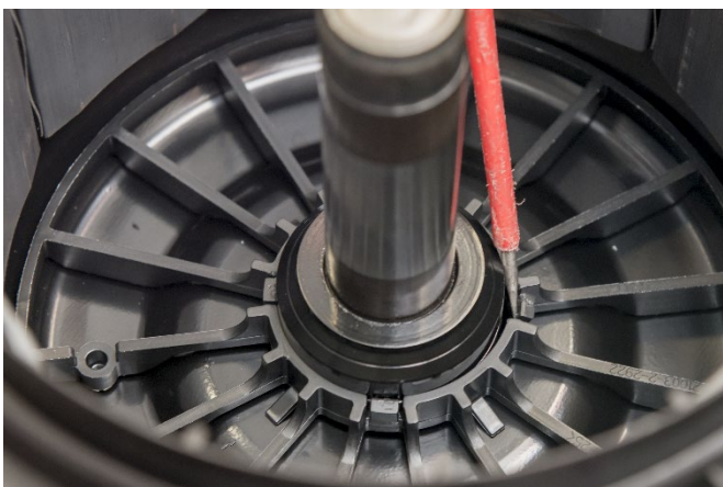
24. Lösen Sie die Verriegelungen (Nasen) am Kühlrad mit einem Schraubendreher.
