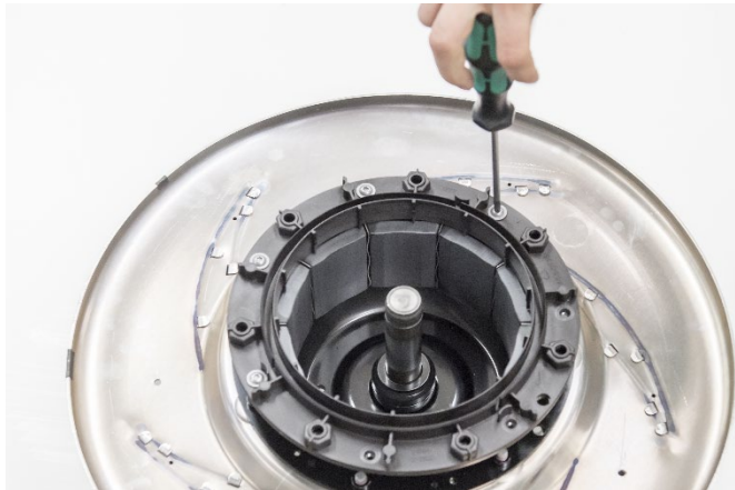
32. Lösen Sie die sieben Schrauben mit einem Schraubendreher.
