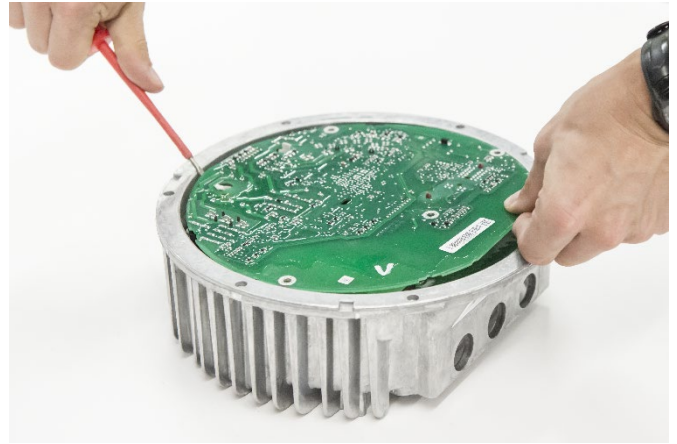
13. Hebeln Sie die Leiterplatte mit einem Schraubendreher heraus
