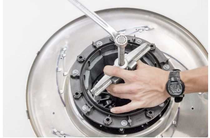
21. Lösen Sie das Kugellager, indem Sie die Spindel des Abziehers im Uhrzeigersinn drehen.
