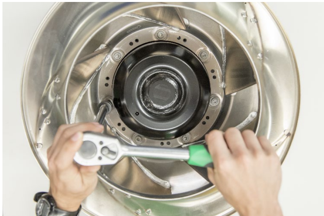
34. Lösen Sie die sieben Schrauben mit einer Ratsche und nehmen Sie das Lüfterrad ab.
