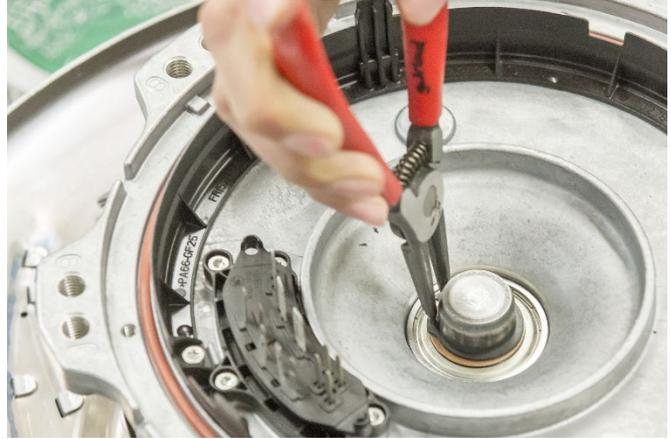
17. Nehmen Sie den Sicherungsring mit einer Sicherungsringzange ab.
