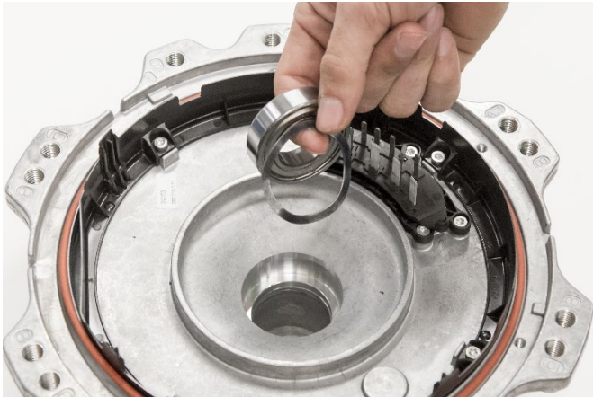
26. Nehmen Sie die restlichen Teile des Kugellagers heraus.
