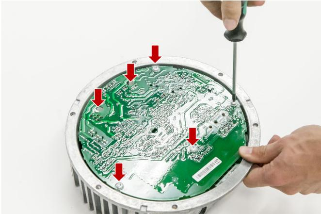
12. Lösen Sie die sechs Schrauben der Leiterplatte.
