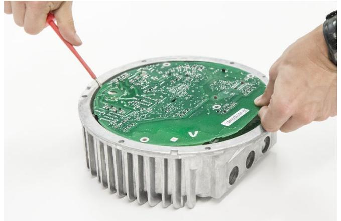
13. Hebeln Sie die Leiterplatte mit einem Schraubendreher heraus
