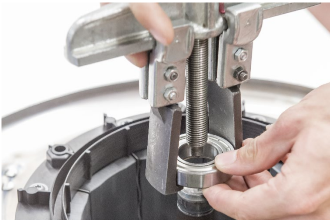
22. Nehmen Sie das Kugellager aus dem Abzieher aus der Rotorglocke heraus.
