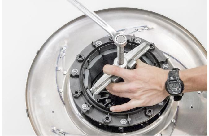
21. Lösen Sie das Kugellager, indem Sie die Spindel des Abziehers im Uhrzeigersinn drehen.
