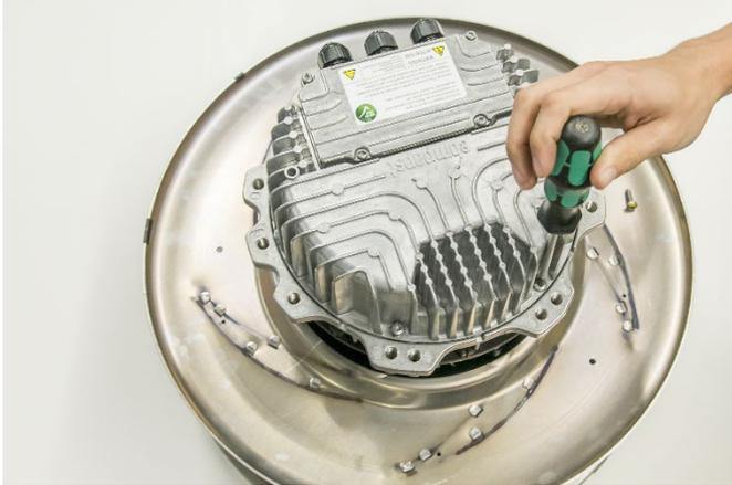
1. Lösen Sie die sechs Schrauben am Gehäuse.
