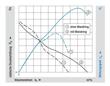
Im Vergleich zu Ventilatoren ohne Wandring bietet die ebm-papst Lösung eine deutlich höhere Luftleistung und damit eine wesentlich bessere Systemeffizienz.
