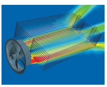
Die CFD-Simulation zeigt die Vorteile des Wandrings.
