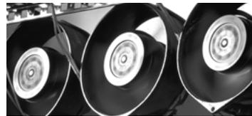
Cabine d'essai chez ebm-papst St. Georgen : 1500 ventilateurs y sont soumis à des tests de résistance à la température jusqu'à défaillance
