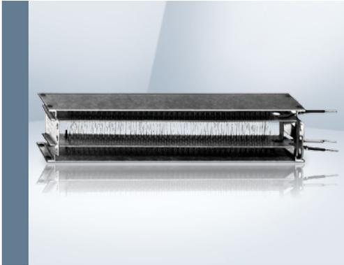
Eléments chauffants avec boîtier, composé de 2 tôles latérales nickelées, permettant leur fixation dans la section de refoulement du ventilateur. Plaques de recouvrement en MULTIMICA®. Limiteur de température intégré, calibré à 105°C plus ou moins 10%. Raccordement électrique par 3 fils souples, longueur 150 mm. Puissance max. = 2 x 1000 W.
