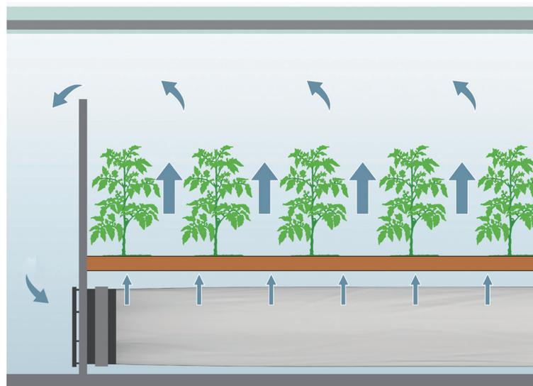
図：換気用ダクトチューブ使用例
