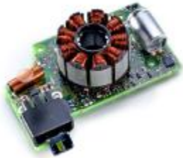
Bild 2: Elektronisch kommutierter Aussenläufermotor als Antrieb für eine Harnstoffeinspritzpumpe
