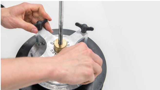
12. Setzen Sie den Abzieher auf und schrauben diesen an allen vier Gewindebohrungen im Stator fest.
