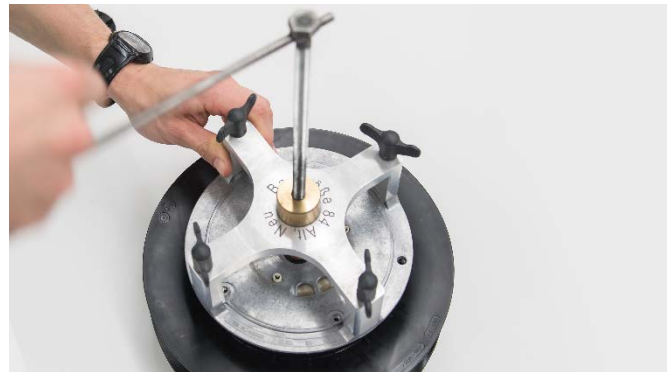
13. Lösen Sie den Stator indem Sie die Spindel im Abzieher im Uhrzeigersinn drehen.
