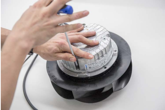
1. Lösen Sie die vier Schrauben am Gehäuse.
