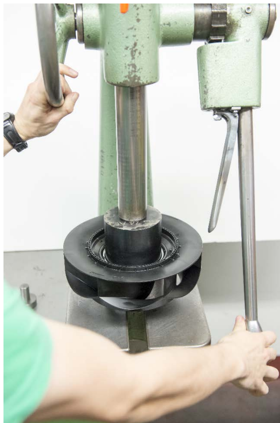
16. Press the rotor out of the fan impeller.
