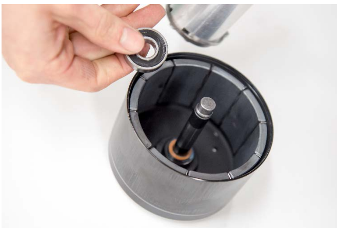
19. Nehmen Sie das Kugellager aus dem Abzieher und die beiden Scheiben aus der Rotorglocke heraus.
