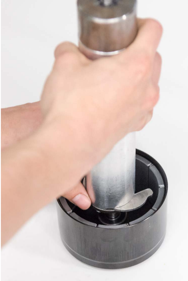
17. Setzen Sie den Abzieher in der Mitte auf und schrauben diesen fest.
