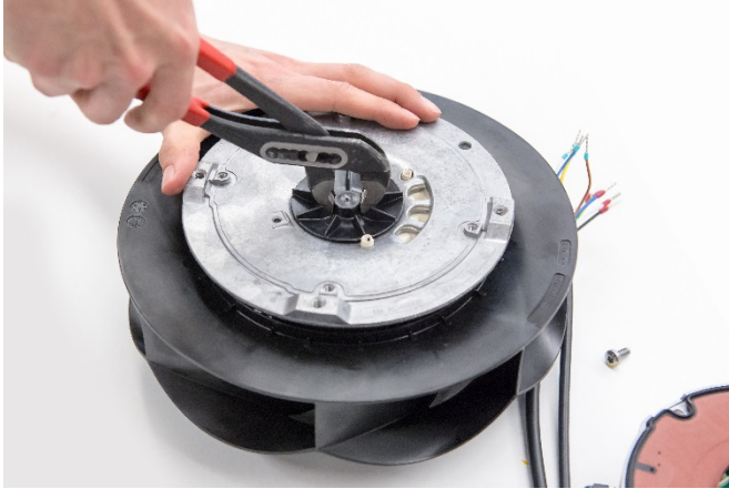
10. Nehmen Sie das kleine Lüfterrad mit einer Wasserpumpenzange ab.
