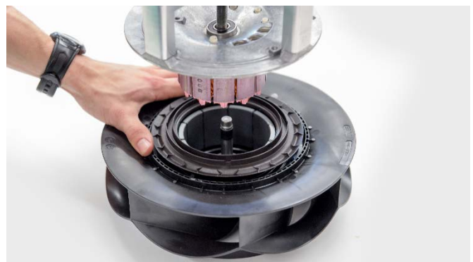
14. Ziehen Sie den Stator mit dem Abzieher heraus. Entfernen Sie danach den Abzieher wieder.
